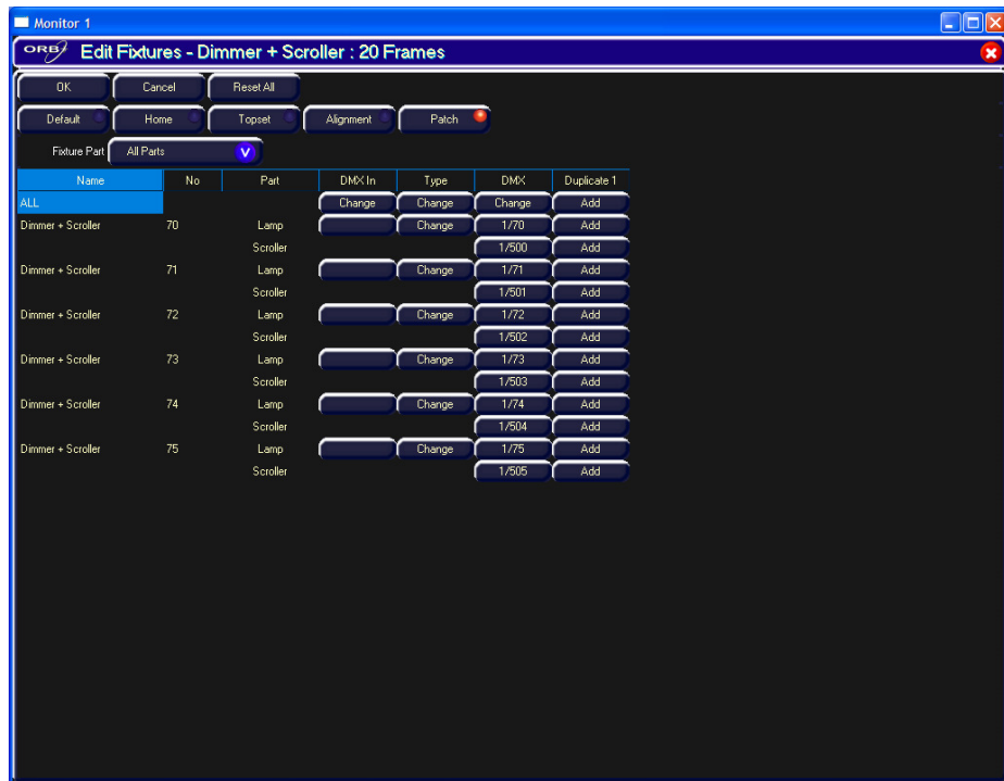
Abbildung 37 - Edit Fixtures (Mehrteilige Fixtures)
