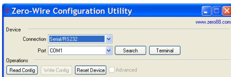
Wählen Sie einen COM-Port aus, an dem das Zero-Wire DMX Modul angeschlossen ist, oder drücken Sie die SEARCH-Taste im Programmfenster, um nach dem COM-Port zu suchen.
