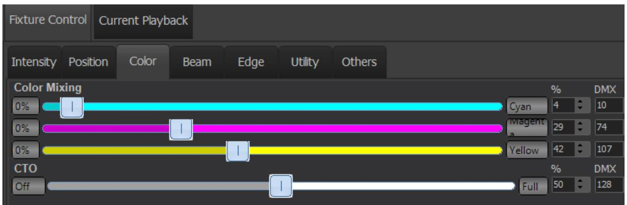
FIGURE 11. NEO CONSOLE COLOR MIX CONTROL USING CMY
