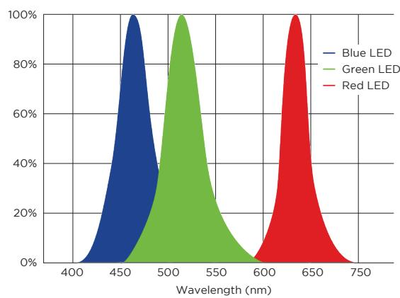
**FIGURE 4. ILLUSTRATION OF RGB LEDS<sup>1</sup>**
