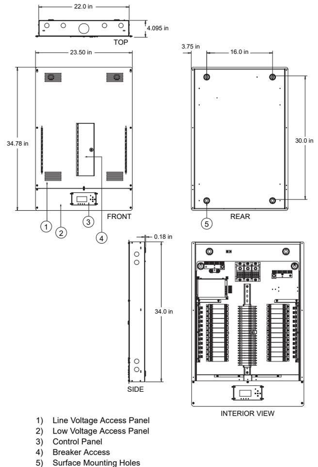
**36-WAY RELAY INSERT PANEL W/ BREAKERS (76922C/76932C)**
