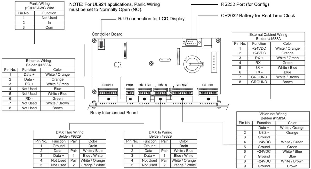
**FIGURE 5. CONTROLLER / RELAY INTERCONNECT PCB CONNECTIONS**
